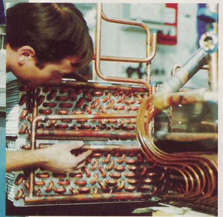
Kupferleitungen für das Kältemittel: andauernder Kreislauf
